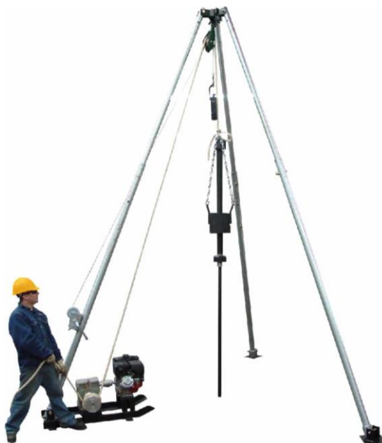
Ilustración 1. Esquema típico del DPSH
