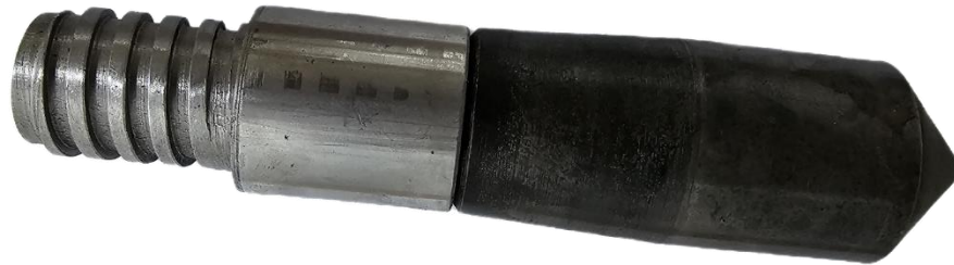
Ilustración 2. Puntaza estandarizada DPSH
